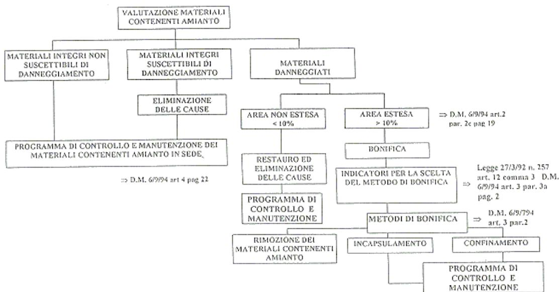
L'art. 7 comma 7- a) fornisce i "principali indicatori utili per valutare lo stato di degrado delle coperture in cementoamianto" che danno utili indicazioni sull'opportunità di procedere alla bonifica mediante incapsulamento.
